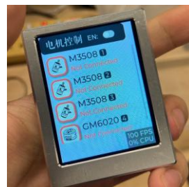
触屏调试器 Touch Screen Debugger
